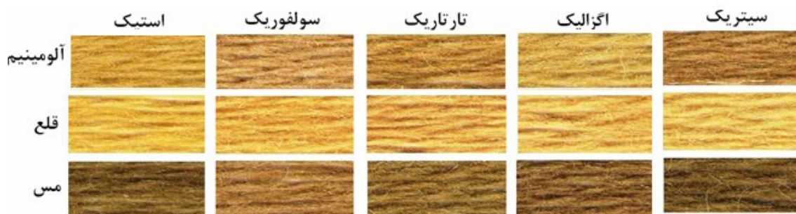
شکل ۷- نمونه های کالای رنگ شده با ۸۰٪ رنگزای میخک در حضور دندانه ها ( زاج سفید ۱۰٪ و بقیه دندانه ها ۵٪) و اسیدهای مختلف (سولفوریک اسید ۰.۴٪ و بقیه اسیدها ۰.۶٪) به روش همزمان
